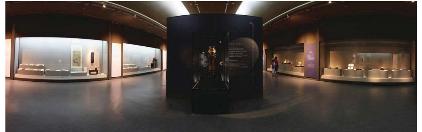
위에 사진에서와 같이 색온도를 우측은 3000K 으로 맞추고, 좌측은 4800K 으로 맞춘 것임
